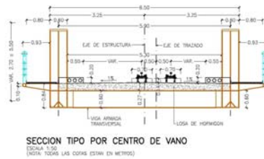
Figura 3. Sección transversal tablero
